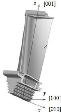
Рис. 1. Геометрія лопатки і схема знаходження осей КГО [100], [010], [001] при збігу з вісями x , y , z
