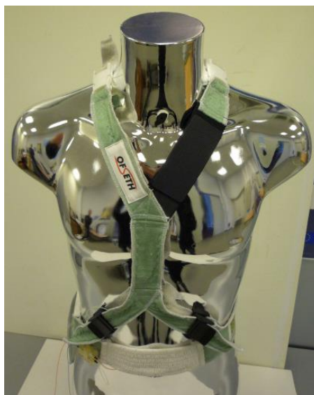
Рис. 1.2. Бандаж, що містить волоконно-оптичні давачі для моніторингу дихання
