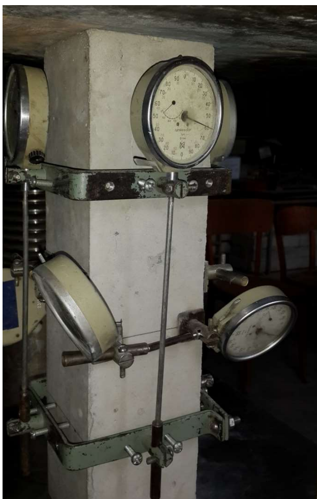
Рис. 6.27. Система індикаторів для вимірювання повздовжніх та поперечних деформацій зразків фібробетону за їх стиску.
