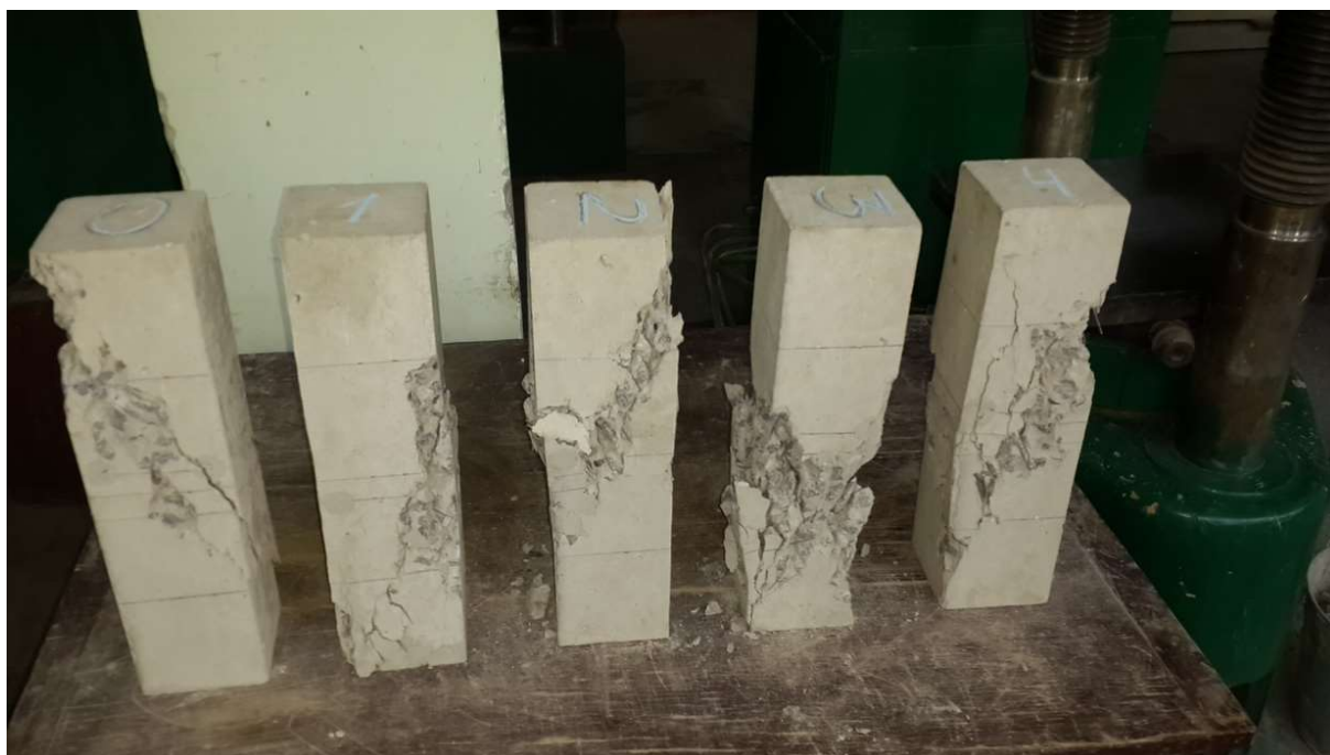
Рис. 6.28. Зруйновані зразки з фібробетону.
