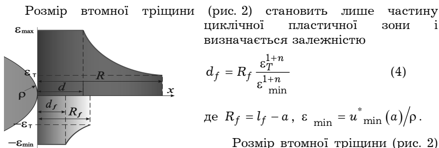
Рис. 2. Розподіл деформацій в околі включення
